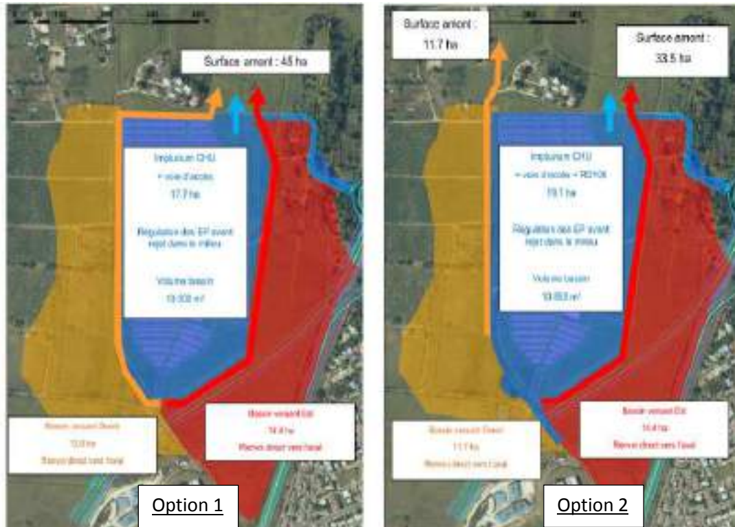
Figure 12 : solutions envisagées pour la gestion des eaux pluviales de la rd106
